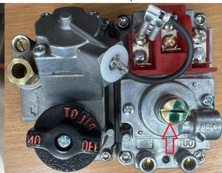
Рис4 Защитный колпачок винта регулировочного клапана управления отоплением
