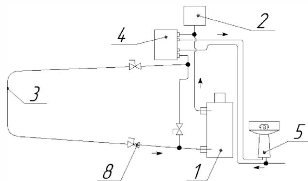
Монтаж бойлера в систему отопления с естественной циркуляцией
