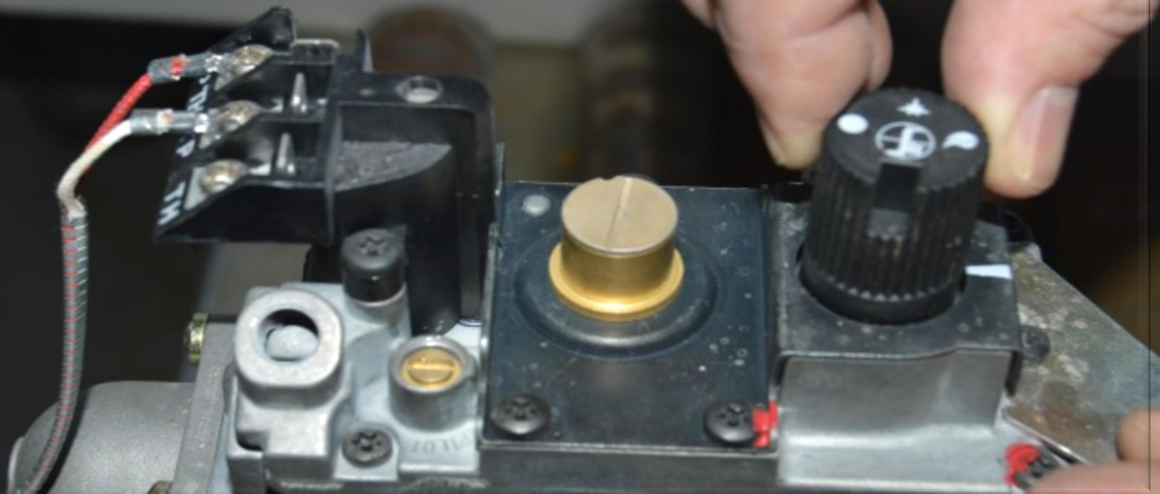
4. Поверните ручку управления терморегулятора в положение соответствующее выбранной температуре.
