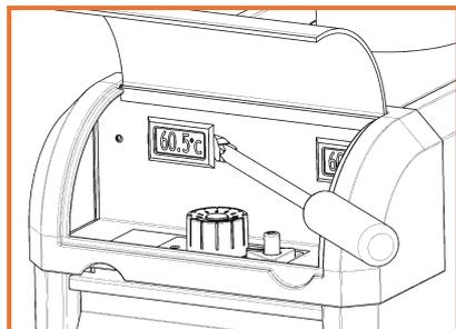
1) Поддеть термометр шлицевой отверткой или другим инструментом с плоской головкой
