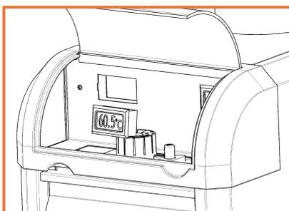
3) Изъять термометр из корпуса
