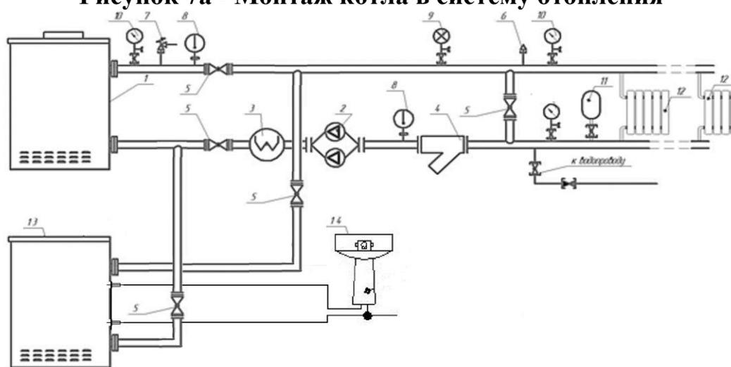
1 – котёл КОВ; 2 – насос; 3 – система водоподготовки; 4 – фильтр; 5 – запорная арматура; 6 – воздухоудалитель автомат; 7 – клапан сбросной предохранительный; 8 – термометр-манометр; 9 – датчик реле давления; 10 – манометр; 11 – расширительный бачок; 12 – радиаторы системы отопления; 13 – бойлер; 14 – умывальник.
