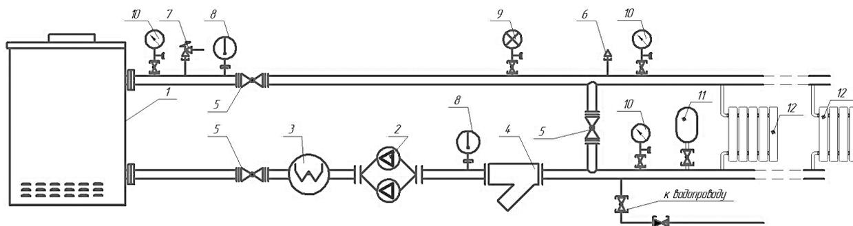
1 – котёл КОВ; 2 – насос; 3 – система водоподготовки; 4 – фильтр; 5 – запорная арматура; 6 – воздухоудалитель автомат; 7 – клапан сбросной предохранительный; 8 – термометр-манометр; 9 – датчик реле давления; 10 – манометр; 11 – расширительный бачок; 12 – радиаторы системы отопления.
