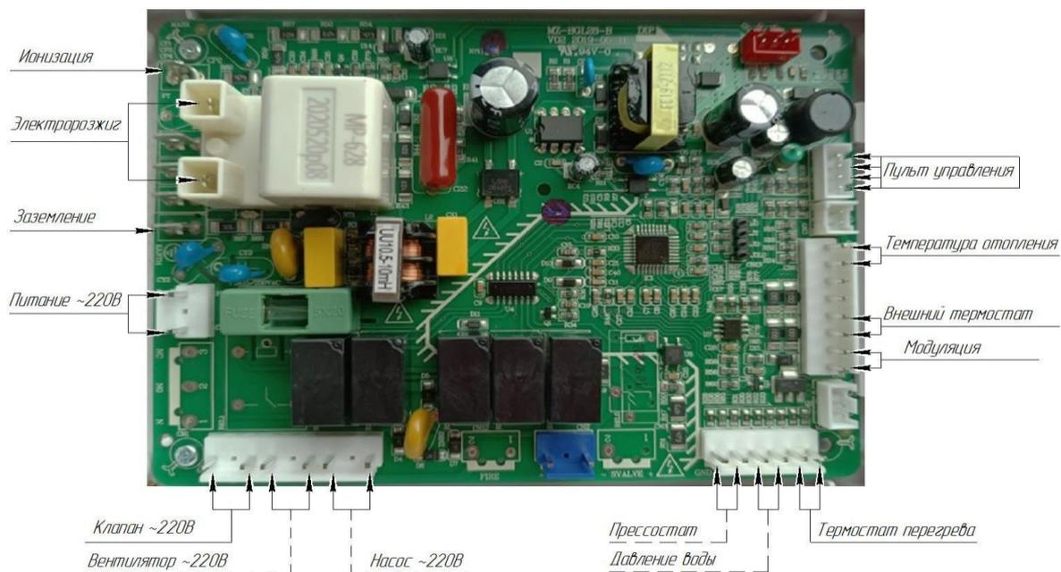
Рисунок 2 – Схема электрических подключений котла КОВ-\_\_СТ1се
