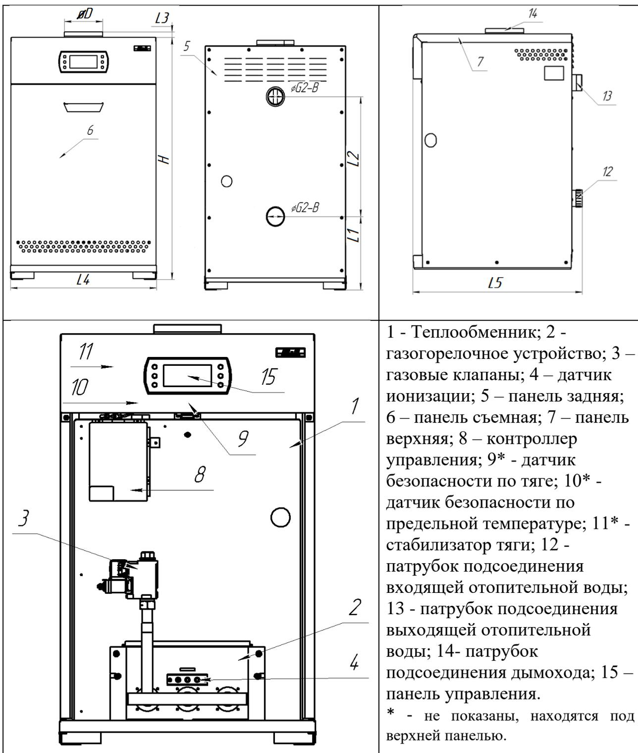
1 - Теплообменник; 2 - газогорелочное устройство; 3 – газовые клапаны; 4 – датчик ионизации; 5 – панель задняя; 6 – панель съемная; 7 – панель верхняя; 8 – контроллер управления; 9\* - датчик безопасности по тяге; 10\* - датчик безопасности по предельной температуре; 11\* - стабилизатор тяги; 12 - патрубок подсоединения входящей отопительной воды; 13 - патрубок подсоединения выходящей отопительной воды; 14- патрубок подсоединения дымохода; 15 – панель управления.
