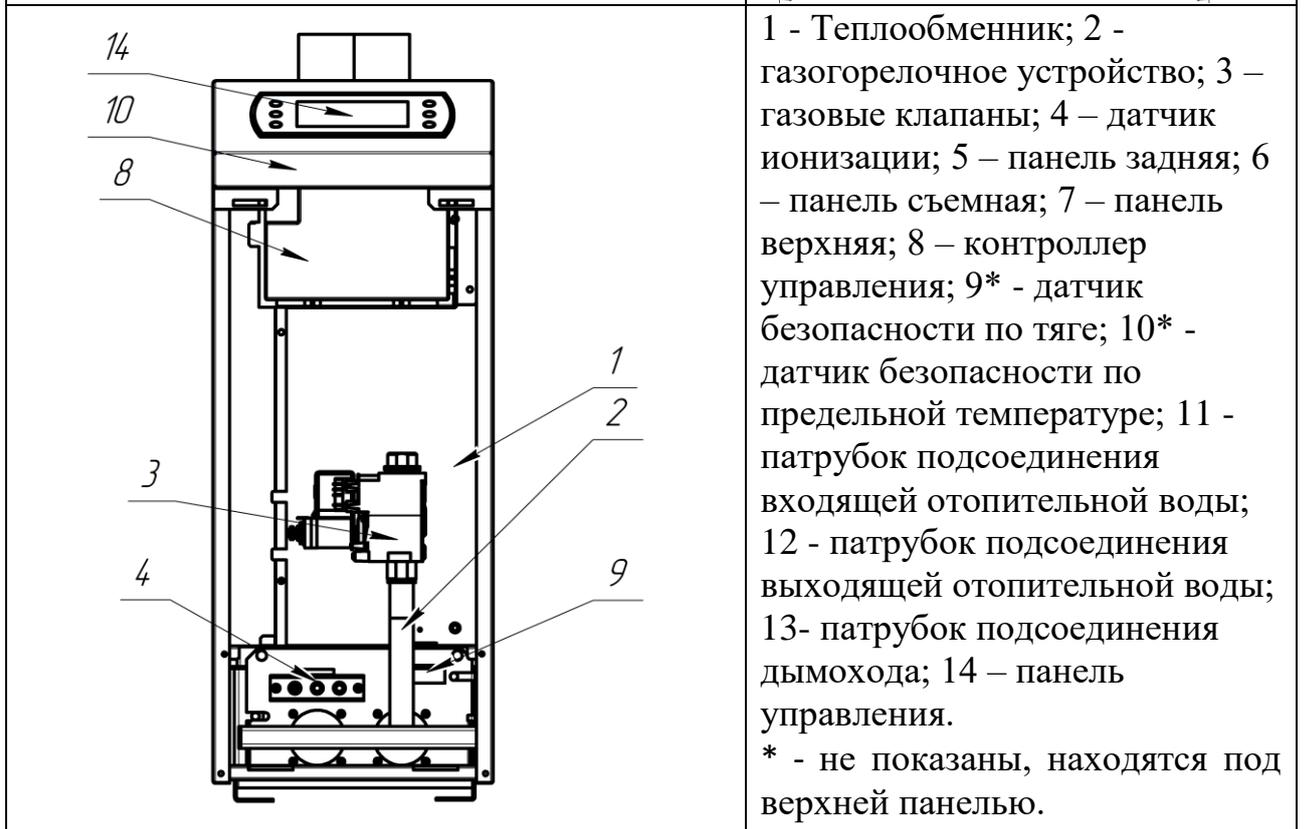
Рисунок 1 – конструкция котла КОВ-СК(В)Се
