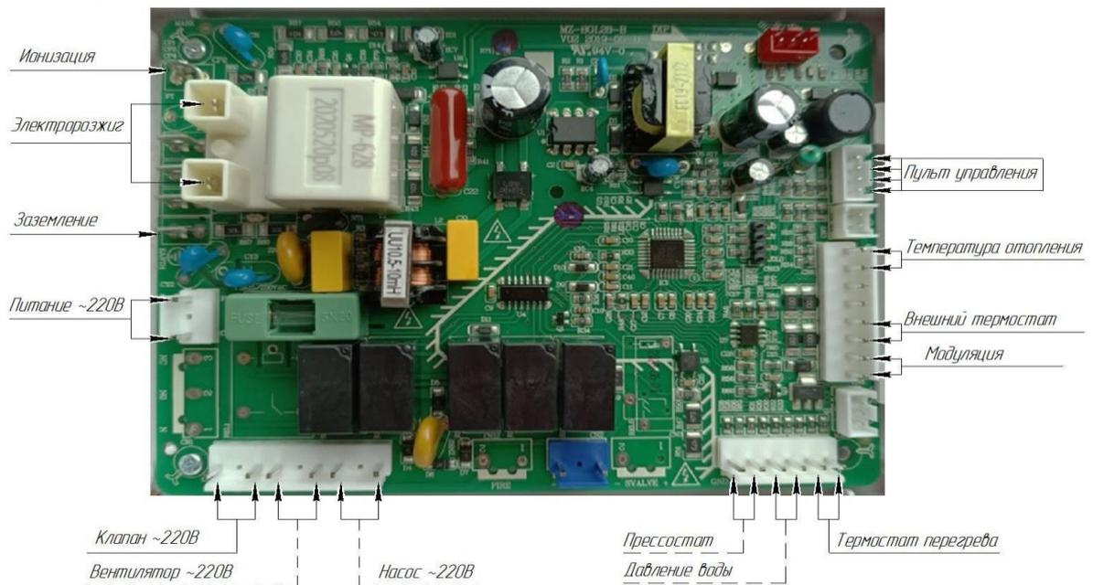
Рисунок 2 - Схема электрических подключений котла КОВ-\_\_\_ СК(В)Се
