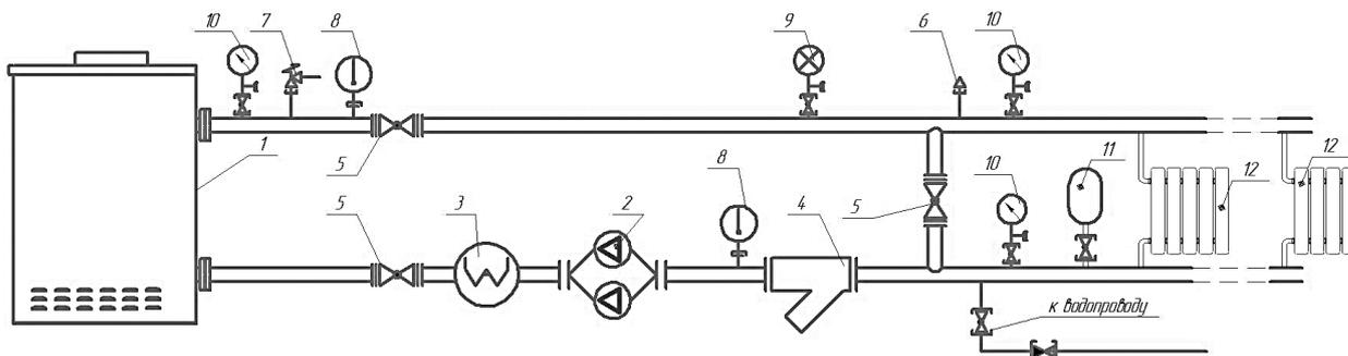
1 – котёл КОВ; 2 – насос; 3 – система водоподготовки; 4 – фильтр; 5 – запорная арматура;
